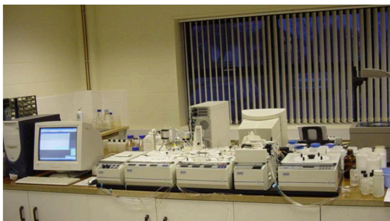
Prototaip penganalisis aliran berterusan awal yang dikembangkan oleh Dr. G. W. Moody di Universiti Cambridge
