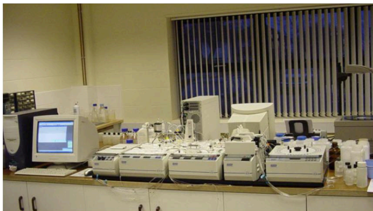
Un premier prototype d'analyseur à débit continu développé par le Dr G. W. Moody à l'Université de Cambridge
