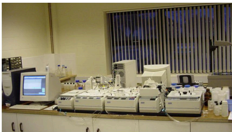
Un prototipo temprano de analizador de flujo continuo desarrollado por el Dr. G. W. Moody en la Universidad de Cambridge
