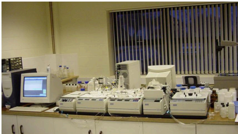
Ein früher Prototyp eines kontinuierlichen Durchflussanalysators, entwickelt von Dr. G. W. Moody an der Universität Cambridge
